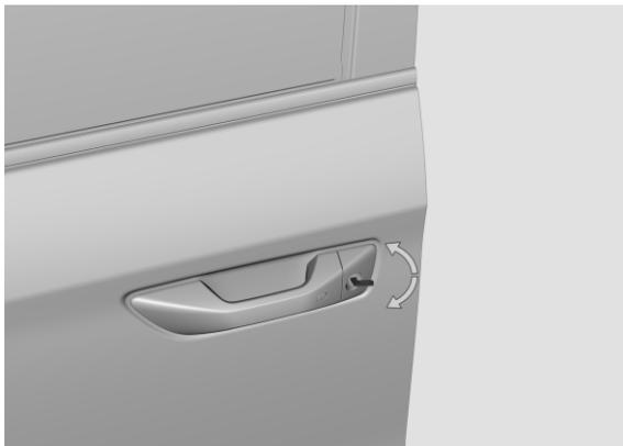
Поверните механический ключ против часовой стрелки для разблокировки замков дверей, и по часовой стрелке - для блокировки замков.
