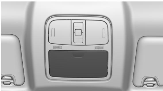
Пенал для очков расположен в потолочном плафоне освещения салона. Для открывания пенала для очков нажмите на крышку пенала. Для закрывания - поднимите крышку пенала для очков вверх и закройте нажатием. При движении автомобиля держите пенал для очков закрытым.
