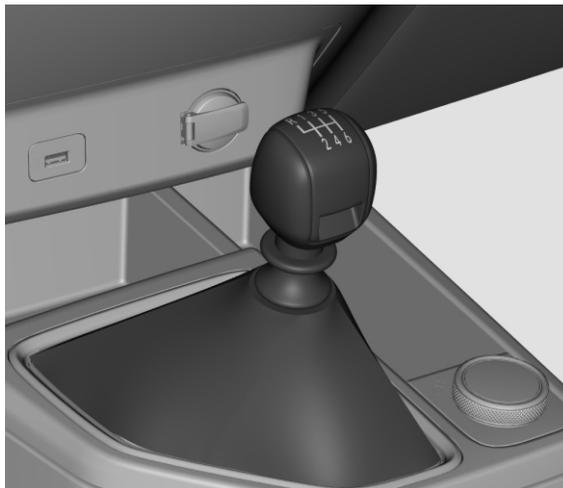
Механическая коробка передач включает шесть передач переднего хода и одну передачу заднего хода. Расположение передач показано на рисунке.
