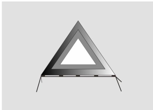
Знак аварийной остановки расположен в багажном отделении. Поднимите напольное покрытие багажного отделения для доступа к знаку аварийной остановки. В случае аварийной остановки необходимо достать и установить предупреждающий знак аварийной остановки в соответствии с правилами дорожного движения, как показано выше.
