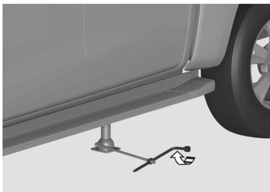
9. С помощью баллонного ключа открутите колесные гайки, и демонтируйте поврежденное колесо.
