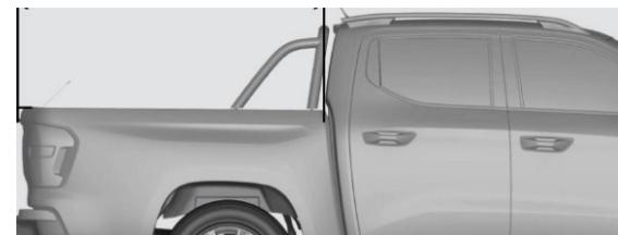
Продольные рейлинги на крыше имеют исключительно декоративную функцию и не предназначены для крепления и перевозки грузов. При необходимости погрузки установите погрузочную балку.
