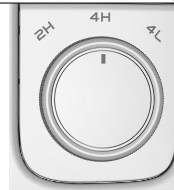
1. Переключения между режимами 2H и 4H: когда электропитание автомобиля включено (положение «ON») и/или двигатель запущен, автомобиль неподвижен или движется по прямой со скоростью менее 80 км/ч, поверните селектор 4WD.
