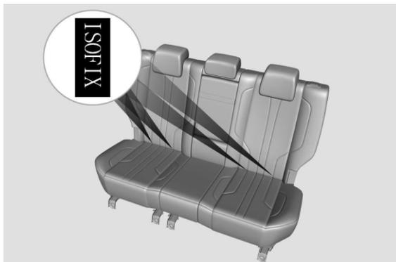
**Нижние точки крепления ISOFIX:** Нижние точки крепления детских удерживающих устройств, соответствующих спецификациям ISOFIX, расположены на стыке спинки и подушки заднего сиденья и закреплены на полу кузова. Обозначение «ISOFIX» расположено снизу, на торце спинки, поможет быстрее найти точки крепления детского удерживающего устройства.
