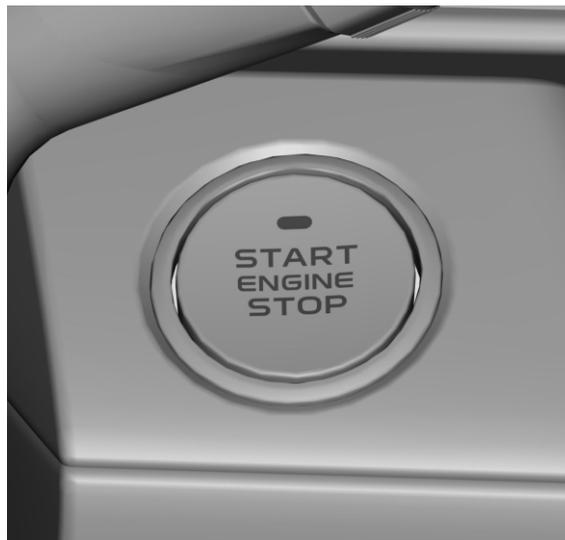
Если SMART - ключ находится в салоне автомобиля (в области активации системы запуска двигателя с кнопки «START ENGINE STOP»), нажмите кнопку «START ENGINE STOP» для запуска/ остановки двигателя или переключения режимов электропитания автомобиля («ACC», «ON» и «OFF»).
