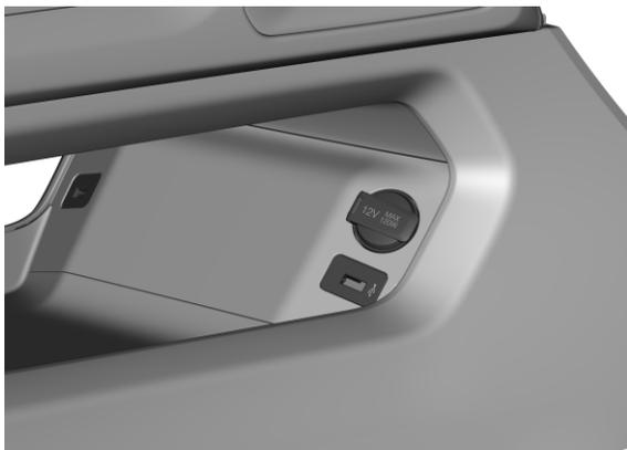
Розетки разделены на: автомобильная розетка питания для пассажиров переднего ряда, порт подключения USB - накопителя для пассажиров переднего ряда, порт USB для зарядки мобильных устройств для пассажиров переднего и заднего рядов.
