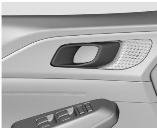
**Разблокировка:** когда все двери автомобиля заблокированы, потяните за дверную ручку один раз, и дверь разблокируется.
