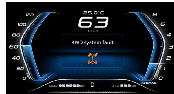
При возникновении неисправности системы полного привода, такой как отказ системы полного привода, связанный с неисправностью электрической цепи или иной неисправностью системы. На дисплее приборной панели появится сообщение «4WD Fault (Неисправность системы полного привода)» и соответствующий символ. При неисправности системы полного привода припаркуйте автомобиль в ближайшем
