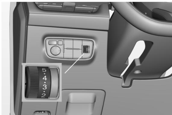
При изменении положения кузова автомобиля в зависимости от загрузки, ускорения, торможения и других условий, влияющих на направление света фар, во избежание ослепления других участников дорожного движения, при помощи регулятора уровня возможна регулировка уровня освещения ближнего света фар.
