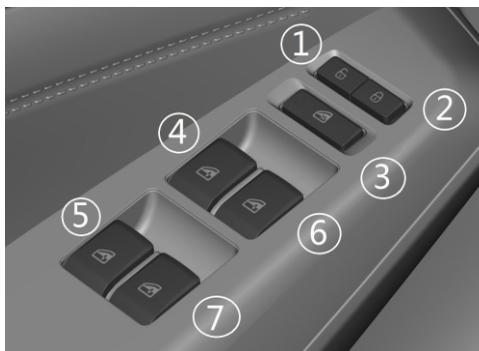
Клавиши управления электрическими стеклоподъемниками:
