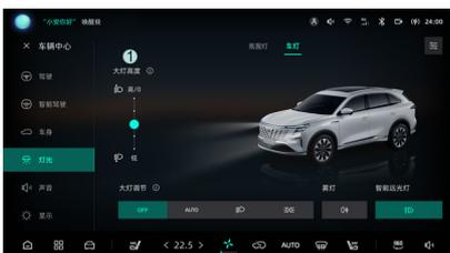
При изменении положения кузова из-за загрузки автомобиля, ускорения или замедления можно отрегулировать угол наклона пучка ближнего света через
