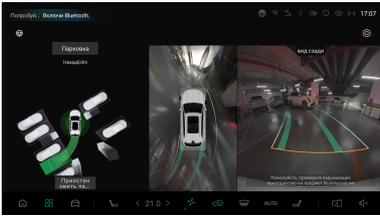
После выезда автомобиля в целевую зону система автоматически активирует парковку и уведомляет о завершении выезда.
