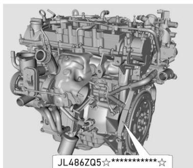
Место нанесения маркировки двигателя JL484ZQ1 показано на рисунке ниже:
