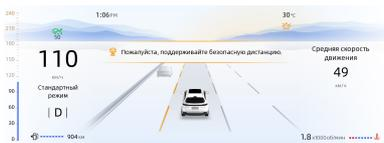
При движении на средней или высокой скорости, если существует риск столкновения с впереди идущей целью, на приборной панели отображается предупреждение «Опасность столкновения» с непрерывным звуковым сигналом, ограничения камеры могут повлиять на производительность системы
