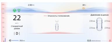
Если опасность столкновения с впереди идущим автомобилем возрастает, функция автоматического экстренного торможения включит кратковременное резкое торможение.
