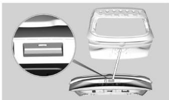
В состоянии разблокировки всех дверей нажмите и удерживайте кнопку открытия двери багажного отделения, поднимите дверь, после достижения положения равновесия дверь автоматически открывается, загорается лампа багажного отделения. Для конфигурации с электрической дверью багажного отделения ✳ после нажатия этой кнопки дверь автоматически поднимается.
