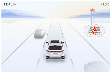
В процессе движения автомобиля, если задний пассажир не пристегнут ремнем безопасности, индикатор на соответствующих позициях загорается, и будет звучать звуковой сигнал. После пристегивания ремней безопасности на всех задних местах индикатор гаснет, а звуковое предупреждение прекращается. В процессе движения автомобиля, если пассажир сначала пристегнул ремень, а затем отстегнул его, индикатор соответствующего положения также загорается и одновременно раздается предупреждающий звук.
