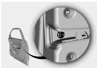
При отсутствии электропитания автомобиля механический ключ может разблокировать/заблокировать только дверь водителя.
