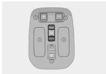
1. Переключатель контроля дверей: нажмите переключатель **【DOOR】**, если в этот момент какая-либо дверь открыта, загорается лампа освещения; после закрытия всех дверей лампа постепенно гаснет. Снова нажмите переключатель, чтобы отключить режим контроля дверей.
