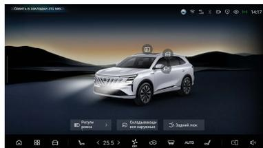
Открытие: когда дверь багажного отделения закрыта, нажмите кнопку **【Дверь багажного отделения】** на экране, электрическая дверь автоматически открывается.
