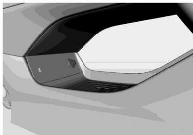
Розетка питания предназначена для переднего ряда. Обеспечивает питание 12 В постоянного тока, мощность подключаемых устройств  $\leq 120$  Вт.
