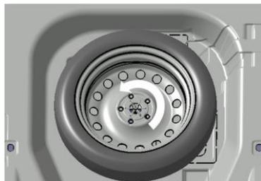
Поверните болт крепления запасного колеса против часовой стрелки, чтобы извлечь запасное колесо.
