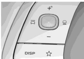
**Режим ECO:** экономичный режим, выбор этого режима обеспечивает лучшую топливную экономичность, но динамика вождения и противоскользкие свойства будут снижены. Подходит только для условий с хорошим сцеплением колес, не используйте этот режим в условиях, где колеса легко скользят; переключитесь в соответствующий режим вождения в соответствии с рекомендуемыми сценариями ниже.
