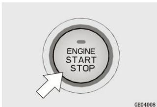
Когда SMART - ключ находится в области активации кнопки запуска двигателя), нажмите кнопку «ENGINE START STOP» для запуска/ остановки двигателя или для переключения режимов электропитания автомобиля («ON» и «OFF»).
