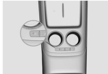
Функция обогрева рулевого колеса※ может быть включена или выключена нажатием переключателя
