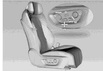
1. Переключатель регулировки положения сиденья вперед/назад и угла наклона подушки, удерживайте переключатель в направлении вперед/назад для управления движением сиденья вперед/назад, удерживайте переключатель вверх/вниз для управления поворотом подушки вверх/вниз;
