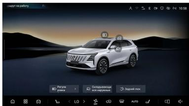
2. Вызовите всплывающее окно регулировки наружных зеркал, нажмите кнопку складывания/раскладывания, чтобы сложить/разложить наружные зеркала.
